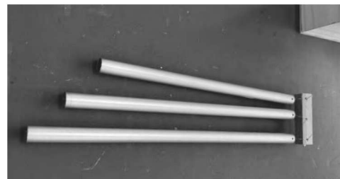
図3 アルミ管を用いた音が鳴る仕組み
